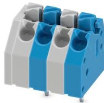
Leiterplattenklemme, Nennstrom: 8 A, Bemessungsspannung (III/2): 400 V, Nennquerschnitt: 1,5 mm<sup>2</sup>, Anzahl der Reihen: 1, Polzahl pro Reihe: 4, Artikelfamilie: PTSA 1,5, Rastermaß: 3,5 mm, Anschlussart: Push-in-Federanschluss, Montage: Wellenlöten, Anschlussrichtung Leiter/Platine: 45 °, Farbe: mehrfarbig, Pin-Layout: Zick-Zack-Pinning W, Pinlänge [P]: 3,5 mm, Anzahl der Löt pins pro Potenzial: 1, Verpackungsart: verpackt im Karton
