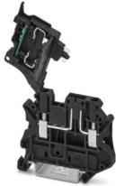
Sicherungsreihenklemme, Art der Sicherung: Glas / Keramik / ..., Sicherungstyp: G / 5 x 20, Nennspannung: 24 V, Nennstrom: 6,3 A, Anschlussart: Schraubanschluss, Bemessungsquerschnitt: 2,5 mm<sup>2</sup>, Querschnitt: 0,14 mm<sup>2</sup>- 4 mm<sup>2</sup>, Montageart: NS 35/7,5, NS 35/15, Farbe: schwarz
