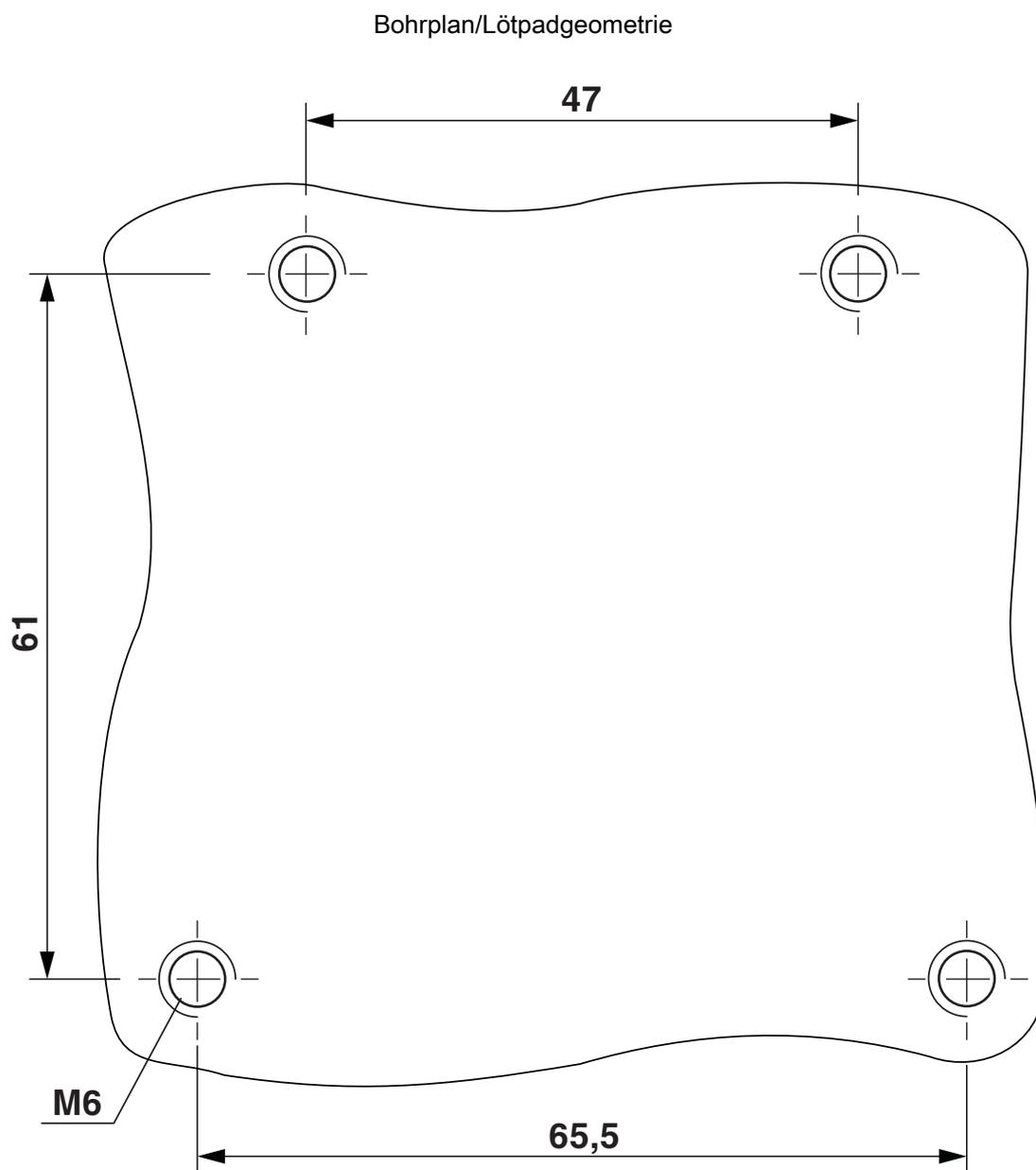
Bohrplan für Montage mit vier M6-Schrauben
