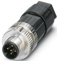
Steckverbinder, 5-polig, Stecker gerade M12 SPEEDCON, Kodierung: A, Federkraftanschluss, Rändelmaterial: Zinkdruckguss, vernickelt, Leitungsaußendurchmesser 4 mm ... 8 mm
