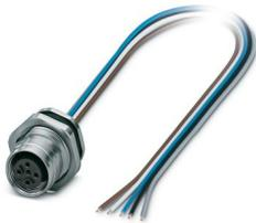
Gerätesteckverbinder Hinterwand, Universal, 8-polig, Buchse, gerade, M12-Push-Pull-Außenverriegelung, A-Kodierung, auf freies Leitungsende, Einzellitzen, Kabellänge: 0,5 m, 0,25 mm<sup>2</sup>, TPE-Litze, vergossen, dieser Artikel ist voraussichtlich ab 2026-Q2 nach RoHS II ohne Ausnahme 6c (Pb < 0,1 %) bleifrei, auf Anfrage ist eine bleifreie Alternative vorab möglich
