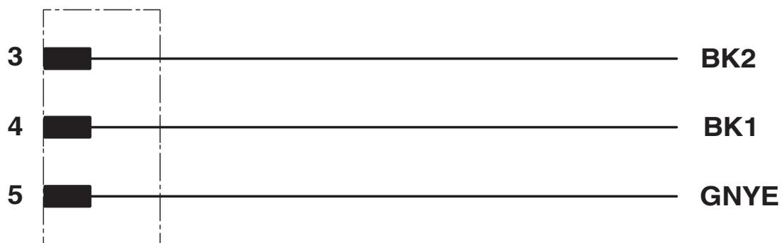
Kontaktbelegung der M12-Buchse
