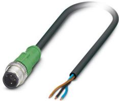
Sensor-/Aktor-Kabel, 3-polig, PVC, schwarz RAL 9005, Stecker gerade M12, Kodierung: A, auf freies Leitungsende, Kabellänge: 5 m
