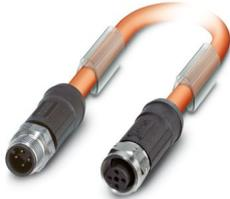
Bussystem-Kabel, FOUNDATION Fieldbus (31,25 kBit/s), 3-polig, PVC, orange RAL 2003, geschirmt, Stecker gerade M12, Kodierung: A, auf Buchse gerade M12, Kodierung: A, Kabellänge: 2 m
