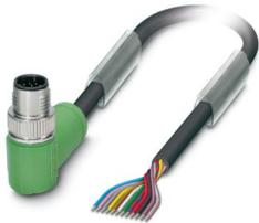
Sensor-/Aktor-Kabel, 12-polig, PUR halogenfrei, schwarz RAL 9005, Stecker gewinkelt M12 SPEEDCON, Kodierung: A, auf freies Leitungsende, Kabellänge: 10 m
