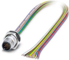
Gerätesteckverbinder Hinterwand, Universal, 17-polig, Stift, gerade, M12-SPEEDCON, A-Kodierung, auf freies Leitungsende, Einzellitzen, Kabellänge: 0,5 m, 0,14 mm<sup>2</sup>, TPE-Litze, vergossen, dieser Artikel ist voraussichtlich ab 2026-Q3 nach RoHS II ohne Ausnahme 6c (Pb < 0,1 %) bleifrei, auf Anfrage ist eine bleifreie Alternative vorab möglich
