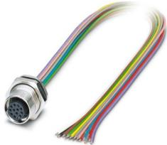
Gerätesteckverbinder Hinterwand, Universal, 12-polig, Buchse, gerade, M12-SPEEDCON, A-Kodierung, auf freies Leitungsende, Einzellitzen, Kabellänge: 0,5 m, 0,14 mm<sup>2</sup>, TPE-Litze, vergossen, dieser Artikel ist voraussichtlich ab 2026-Q3 nach RoHS II ohne Ausnahme 6c (Pb < 0,1 %) bleifrei, auf Anfrage ist eine bleifreie Alternative vorab möglich
