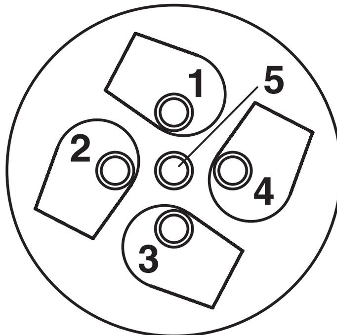
Kabelanschlusseite M12 (Schraubanschluss)
