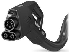
CHARX connect professional, CCS Typ 1, HPC-DC-Ladeleitung, bis zu 700 A im Boost Mode, 500 A dauerhaft, 1000 V DC, mit gekühltem Fahrzeug-Ladestecker und gekühlter Leitung, Kabel: 6 m, schwarz, gerade, mit Ladesteckerhalterung, mit austauschbarem Steckgesichtrahmen, ohne Wanddurchführung, mit digitaler Temperatursensorik, PHOENIX CONTACT-Logo, SAE J1772, IEC 62196-3-1, zum Laden mit Gleichstrom (DC) von Elektrofahrzeugen (EV)
