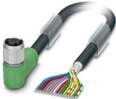
Sensor-/Aktor-Kabel, 17-polig, PUR/PVC, schwarz RAL 9005, geschirmt, freies Leitungsende, auf Buchse gewinkelt M12 SPEEDCON, Kodierung: A, Kabellänge: 1,5 m
