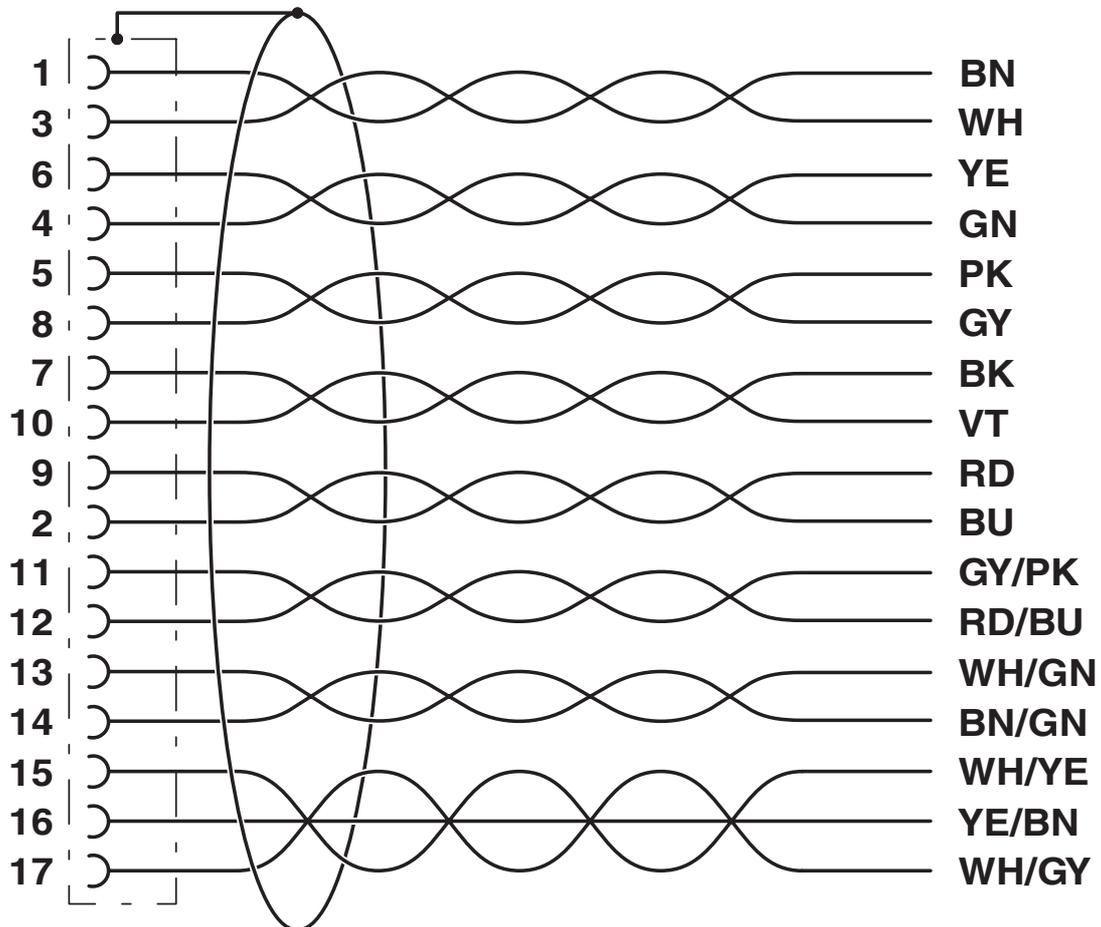
Kontaktbelegung der M12-Buchse
