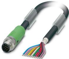
Sensor-/Aktor-Kabel, 12-polig, PUR/PVC, schwarz RAL 9005, geschirmt, Stecker gerade M12 SPEEDCON, Kodierung: A, auf freies Leitungsende, Kabellänge: 10 m
