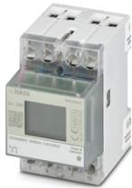
CHARX control modular, 3-Phasen-Energiezähler zur Wirkleistungsmessung mit Direktmessung in Netzen bis 400 V/40 A, mit RS-485-Schnittstelle, zertifiziert gemäß MID-Richtlinie
