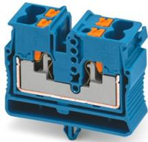
Minidurchgangsklemme, Nennspannung: 800 V, Nennstrom: 24 A, Anzahl der Anschlüsse: 4, Polzahl: 1, Anschlussart: Push-in-Anschluss, Bemessungsquerschnitt: 2,5 mm<sup>2</sup>, Querschnitt: 0,14 mm<sup>2</sup> - 4 mm<sup>2</sup>, Montageart: Rastzapfenmontage, Farbe: blau
