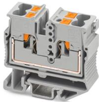
Minidurchgangsklemme, Nennspannung: 800 V, Nennstrom: 24 A, Anzahl der Anschlüsse: 4, Polzahl: 1, Anschlussart: Push-in-Anschluss, Bemessungsquerschnitt: 2,5 mm<sup>2</sup>, Querschnitt: 0,14 mm<sup>2</sup> - 4 mm<sup>2</sup>, Montageart: NS 15, Farbe: grau
