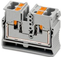
Minidurchgangsklemme, Nennspannung: 800 V, Nennstrom: 24 A, Anzahl der Anschlüsse: 4, Polzahl: 1, Anschlussart: Push-in-Anschluss, Bemessungsquerschnitt: 2,5 mm<sup>2</sup>, Querschnitt: 0,14 mm<sup>2</sup> - 4 mm<sup>2</sup>, Farbe: grau
