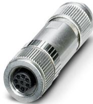
Datensteckverbinder, VARAN, 6-polig, geschirmt, Buchse gerade M12, Kodierung: A, Schneidklemmanschluss, Rändelmaterial: Messing, vernickelt, Leitungsaußendurchmesser 4 mm ... 8 mm
