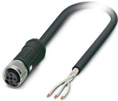
Sensor-/Aktor-Kabel, 3-polig, PE-X halogenfrei, schwarz, geschirmt, freies Leitungsende, auf Buchse gerade M12 SPEEDCON, Kodierung: A, Kabellänge: 2,4 m, für Bahnanwendungen
