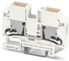
Schirmanschlussklemme, Nennspannung: 48 V, Anschlussart: Push-X-Anschluss, Bemessungsquerschnitt: 16 mm<sup>2</sup>, Querschnitt: 2,5 mm<sup>2</sup> - 25 mm<sup>2</sup>, Montageart: NS 35/7,5, NS 35/15, Farbe: weiß
