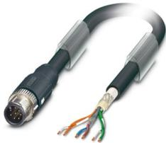
Bussystem-Kabel, VARAN (100 MBit/s), 6-polig, SANTOPRENE halogenfrei/TPE halogenfrei, schwarz RAL 9005, geschirmt, Stecker gerade M12 SPEEDCON, Kodierung: A, auf freies Leitungsende, Kabellänge: 2 m
