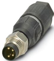
Steckverbinder, 4-polig, Stecker gerade M8, Kodierung: A, Schneidklemmanschluss, Rändelmaterial: Edelstahl 1.4305, Leitungsaußendurchmesser 2,5 mm ... 5 mm
