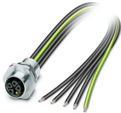
Gerätesteckverbinder Vorderwand, Leistung, 5-polig, Buchse, gerade, M12-Standard, K-Kodierung, auf freies Leitungsende, Einzellitzen, Kabellänge: 0,2 m, 1,31 mm<sup>2</sup>, UL/cUL Schaltlitze, vergossen, dieser Artikel ist voraussichtlich ab 2026-Q1 nach RoHS II ohne Ausnahme 6c (Pb < 0,1 %) bleifrei, auf Anfrage ist eine bleifreie Alternative vorab möglich
