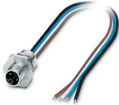
Gerätesteckverbinder Vorderwand, Leistung, 4-polig, Stift, gerade, M12-Standard, L-Kodierung, auf freies Leitungsende, Einzellitzen, Kabellänge: 0,2 m, 2,50 mm<sup>2</sup>, PEX-Litze, vergossen, dieser Artikel ist voraussichtlich ab 2027-Q1 nach RoHS II ohne Ausnahme 6c (Pb < 0,1 %) bleifrei, auf Anfrage ist eine bleifreie Alternative vorab möglich
