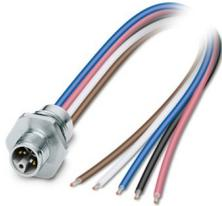
Gerätesteckverbinder Vorderwand, Leistung, 5-polig, Stift, gerade, M12-Standard, L-Kodierung, auf freies Leitungsende, Einzellitzen, Kabellänge: 0,2 m, 2,50 mm<sup>2</sup>, PEX-Litze, vergossen, dieser Artikel ist voraussichtlich ab 2027-Q1 nach RoHS II ohne Ausnahme 6c (Pb < 0,1 %) bleifrei, auf Anfrage ist eine bleifreie Alternative vorab möglich
