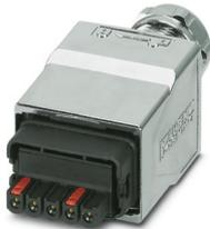
Power-Steckverbinder, Schutzart: IP65/IP67, Polzahl: 5, Material: Metall, Anschlussart: Federkraftanschluss, Anschlussquerschnitt: AWG 18- 13, Kabelabgang: gerade, Universal
