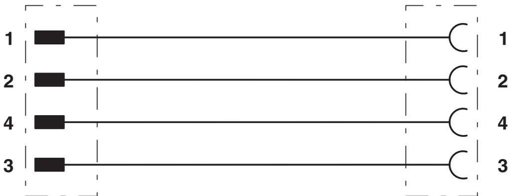
Kontaktbelegung der M12-Stecker/Buchse
