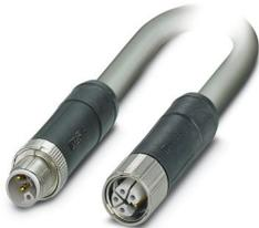
Powerleitung, 5-polig, PVC, grau RAL 7001, Stecker gerade M12, Kodierung: L, auf Buchse gerade M12, Kodierung: L, Kabellänge: 0,3 m, für Gleichstrom bis 16 A / 63 V
