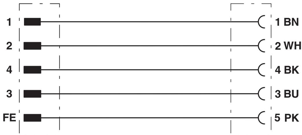
Kontaktbelegung der M12-Stecker/Buchse
