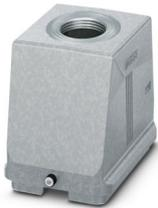
Tüllengehäuse B48, für Längsbügel, Material: Aluminiumdruckguss, seewasserbeständig, Kabelabgänge: 1, gerade, 1x Pg29, Höhe: 107,5 mm, Kabelverschraubung: ohne, Standard
