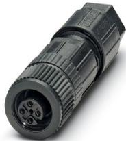
Steckverbinder, Universal, 5-polig, ungeschirmt, Buchse gerade M12, Kodierung: A, Push-Lock-Federanschluss, Rändelmaterial: Kunststoff, Leitungsaußendurchmesser 4 mm ... 8 mm
