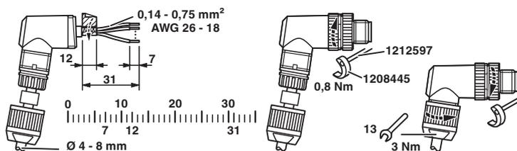
Druckmutter und Tüllengehäuse auf die Leitung schieben, Leitung abmanteln, Schirm kürzen, Einzeladern abisolieren, Adern anschließen, bei geradem Tüllengehäuse Adern leicht miteinander verdrehen, Schirmfolie um den gekürzten Schirm kleben, bei Leitungsaußendurchmesser < 6 mm eine zusätzliche Schirmfolie um das Adernpaket kleben, Tüllengehäuse mit dem Steckereinsatz verschrauben, Druckmutter festschrauben.
