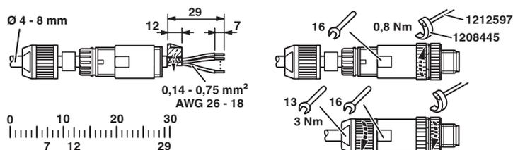
Druckmutter und Tüllengehäuse auf die Leitung schieben, Leitung abmanteln, Schirm kürzen, Einzeladern abisolieren, Adern anschließen, bei geradem Tüllengehäuse Adern leicht miteinander verdrehen, Schirmfolie um den gekürzten Schirm kleben, bei Leitungsaußendurchmesser < 6 mm eine zusätzliche Schirmfolie um das Adernpaket kleben, Tüllengehäuse mit dem Steckereinsatz verschrauben, Druckmutter festschrauben.
