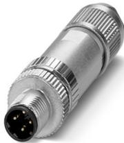
Steckverbinder, PROFINET CAT5 (100 MBit/s), 4-polig, geschirmt, Stecker gerade M12, Kodierung: D, Push-Lock-Federanschluss, Rändelmaterial: Zinkdruckguss, vernickelt, Leitungsaußendurchmesser 4 mm ... 8 mm
