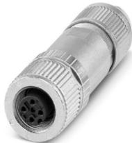
Steckverbinder, Universal, 5-polig, geschirmt, Buchse gerade M12, Kodierung: A, Push-Lock-Federanschluss, Rändelmaterial: Zinkdruckguss, vernickelt, Leitungsaußendurchmesser 4 mm ..
