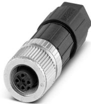
Steckverbinder, Universal, 5-polig, ungeschirmt, Buchse gerade M12, Kodierung: A, Push-Lock-Federanschluss, Rändelmaterial: Zinkdruckguss, vernickelt, Leitungsaußendurchmesser 4 mm ..
