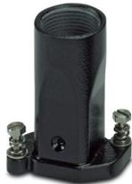
Tüllengehäuse D7, mit Schraubverriegelung, Material: Zinkdruckguss, Kabelabgänge: 1, gerade, 1x M25, Höhe: 60 mm, Kabelverschraubung: ohne, Schutzdeckel: nein, Bahnanwendungen, für erhöhte Umwelt- und EMV-Anforderungen, Serie HPR
