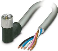
Powerleitung, 5-polig, PUR halogenfrei, grau RAL 7001, freies Leitungsende, auf Buchse gewinkelt M12, Kodierung: L, Kabellänge: 5 m, für Gleichstrom bis 12 A / 63 V
