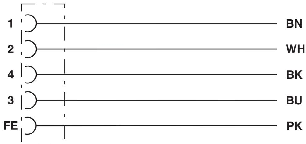
Kontaktbelegung der M12-Buchse
