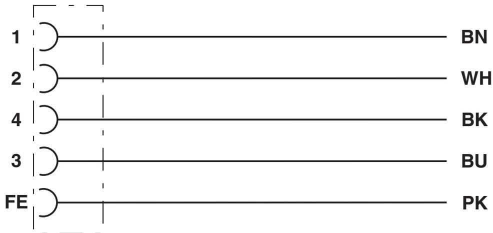
Kontaktbelegung der M12-Buchse
