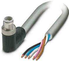
Powerleitung, 5-polig, PUR halogenfrei, grau RAL 7001, Stecker gewinkelt M12, Kodierung: L, auf freies Leitungsende, Kabellänge: 5 m, für Gleichstrom bis 12 A / 63 V
