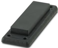
Kabeldurchführungsplatte, Anzahl der Leitungen: 10, Leitungsaußendurchmesser: 6x 2 mm ... 8 mm, 2x 2 mm ... 18 mm, 2x 2 mm ... 30 mm, Material: PP (Kern), Material: TPE-SEBS (außenliegendes Material), Farbe: schwarz, Länge: 154 mm, Breite: 56 mm, Höhe: 20 mm
