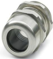
Kabelverschraubung, Material Verschraubung: Edelstahl 1.4305, Anwendung: Standard, Kabelaußendurchmesser 19 mm ... 28 mm, Schirmung: nein, Anschlussgewinde: M40 x 1,5, Farbe: silberfarben, mit O-Ring
