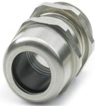
Kabelverschraubung, Material Verschraubung: Edelstahl 1.4305, Anwendung: Standard, Kabelaußendurchmesser 11 mm ... 17 mm, Schirmung: nein, Anschlussgewinde: M25 x 1,5, Farbe: silberfarben, mit O-Ring
