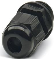
Kabelverschraubung, Material Verschraubung: PA, Anwendung: Standard, Kabelaußendurchmesser 4 mm ... 7 mm, Schirmung: nein, Anschlussgewinde: M16 x 1,5, Farbe: tiefschwarz RAL 9005, mit Druckausgleichselement und Flachdichtung
