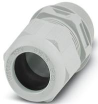
Kabelverschraubung, Material Verschraubung: PA, Anwendung: Standard, Kabelaußendurchmesser 13 mm ... 21 mm, Schirmung: nein, Anschlussgewinde: M32 x 1,5, Farbe: lichtgrau RAL 7035
