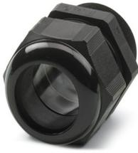
Kabelverschraubung, Material Verschraubung: PA, Anwendung: Standard, Kabelaußendurchmesser 30 mm ... 38 mm, Schirmung: nein, Anschlussgewinde: Pg42, Farbe: tiefschwarz RAL 9005
