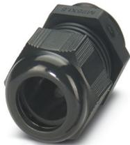
Kabelverschraubung, Material Verschraubung: PA, Anwendung: Standard, Kabelaußendurchmesser 5 mm ... 10 mm, Schirmung: nein, Anschlussgewinde: Pg11, Farbe: tiefschwarz RAL 9005
