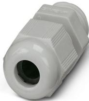
Kabelverschraubung, Material Verschraubung: PA, Anwendung: Standard, Kabelaußendurchmesser 4 mm ... 8 mm, Schirmung: nein, Anschlussgewinde: M16 x 1,5, Farbe: lichtgrau RAL 7035
