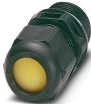
Kabelverschraubung, Material Verschraubung: PA, Anwendung: Ex, Kabelaußendurchmesser 7 mm ... 13 mm, Schirmung: nein, Anschlussgewinde: M20 x 1,5, Farbe: tiefschwarz RAL 9005, mit Flachdichtung
